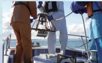
採泥器による採泥作業
