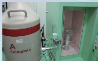
高純度ゲルマニウム半導体検出器による放射性核種の同定、定量
