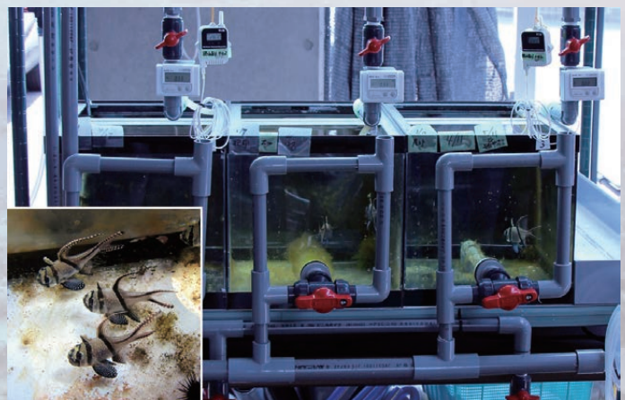
魚類複数世代影響試験と試験水槽内で飼育中のアマノガワテンジクダイ親魚(白枠内)
