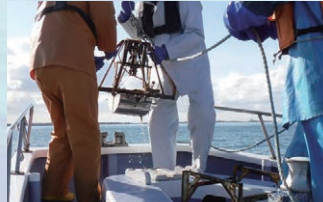
採泥器による採泥作業
