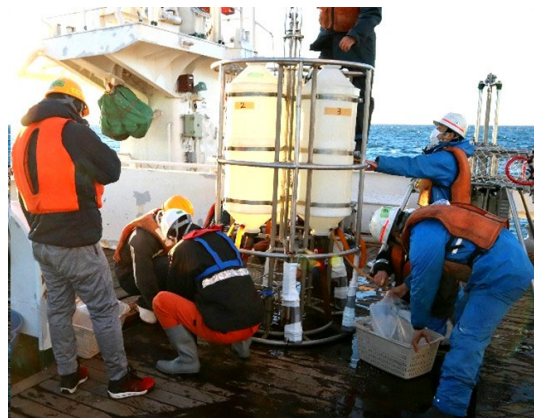
海水試料の採取作業 (20リットル容器に分取している様子)
