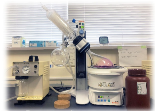
トリチウム分析における電解濃縮前に、減圧蒸留を行うための準備をしているところ
