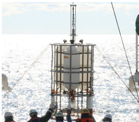
大型バンドーン採水器による採水作業
