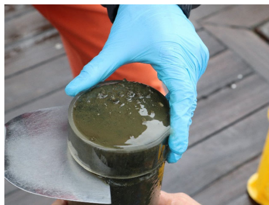
海底土試料の採取作業 (柱状試料として採取した海底土を表層3cmにスライスして分取している様子)
