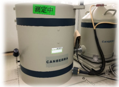
ガンマ線スペクトロメーターに用いる高純度ゲルマニウム半導体検出器(一例)。「測定中」の部分は鉛の遮蔽で、右は液体窒素デュー容器
