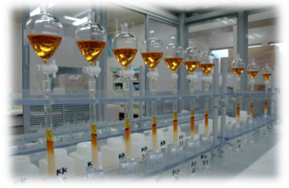
プルトニウム-239+240分析での化学分離・精製に用いる陰イオン交換樹脂カラム(一例)
